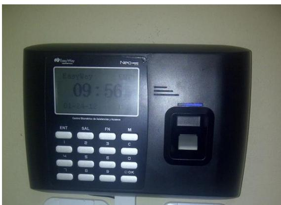
Este aparato está destinado para el registro digital de ingreso y salida a las actividades laborales, mediante la huella dactilar del dedo pulgar del servidor.
