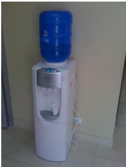
Este artefacto funciona con energía de 110v, contiene doble cable y boquillas, una para agua caliente y otra para agua fría.
